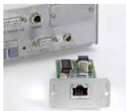
Zweite RS232C 11 132 500 Ethernet 11 132 515 Weitere Schnittstellenoptionen verfügbar
