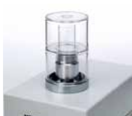
Pipettenkalibriergerät mit Verdunstungsfall 11 138 010
